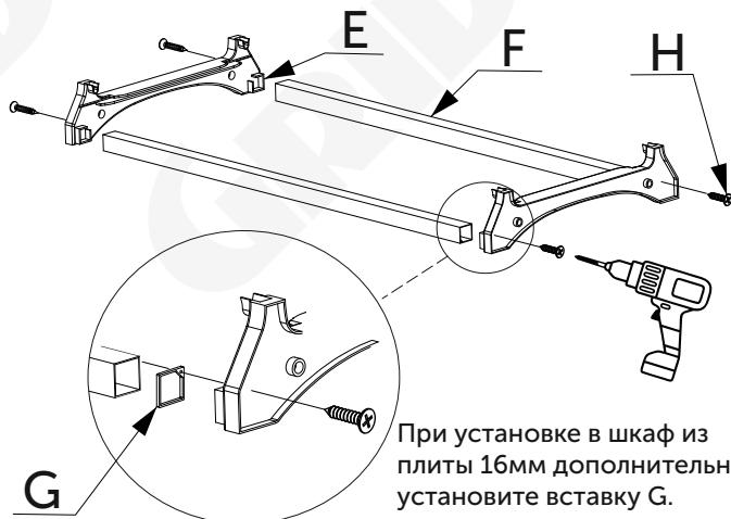
При установке в шкаф из плиты 16мм дополнительно установите вставку G.
