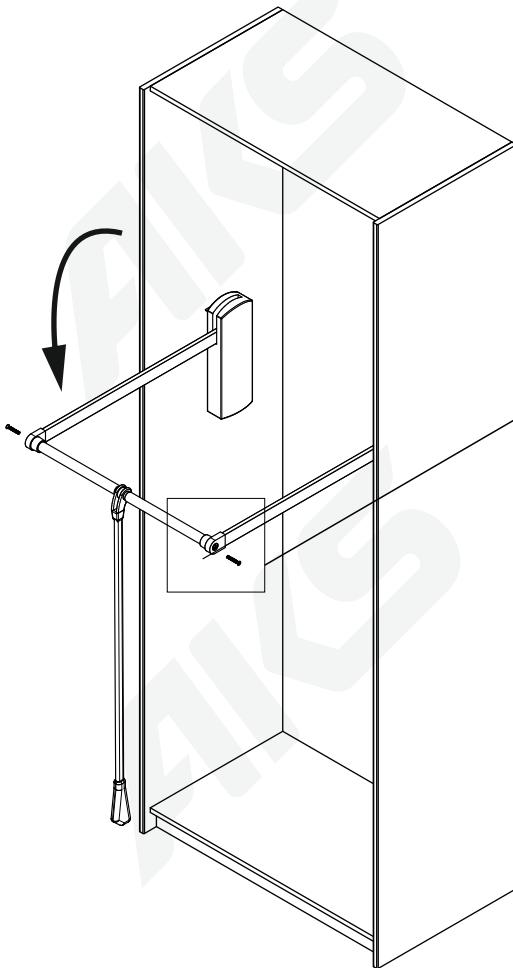
Установите соединители (D) на штангу (B), установите штангу на тяги подъемников (A).
